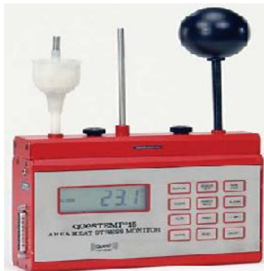
Gambar.7.. Area Heat Stress Monitor, fungsingnya untuk mengetahui temperature, humaditu, suhu basah, suhu kering, dan suhu bola/globe WBGT/ISBB- indeks suhu basa dan bola
