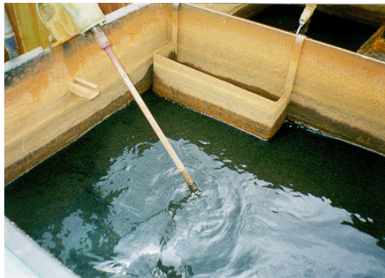
Gambar 9. Pemberian koagulan (ferro sulfat) untuk menghilangkan warna.
