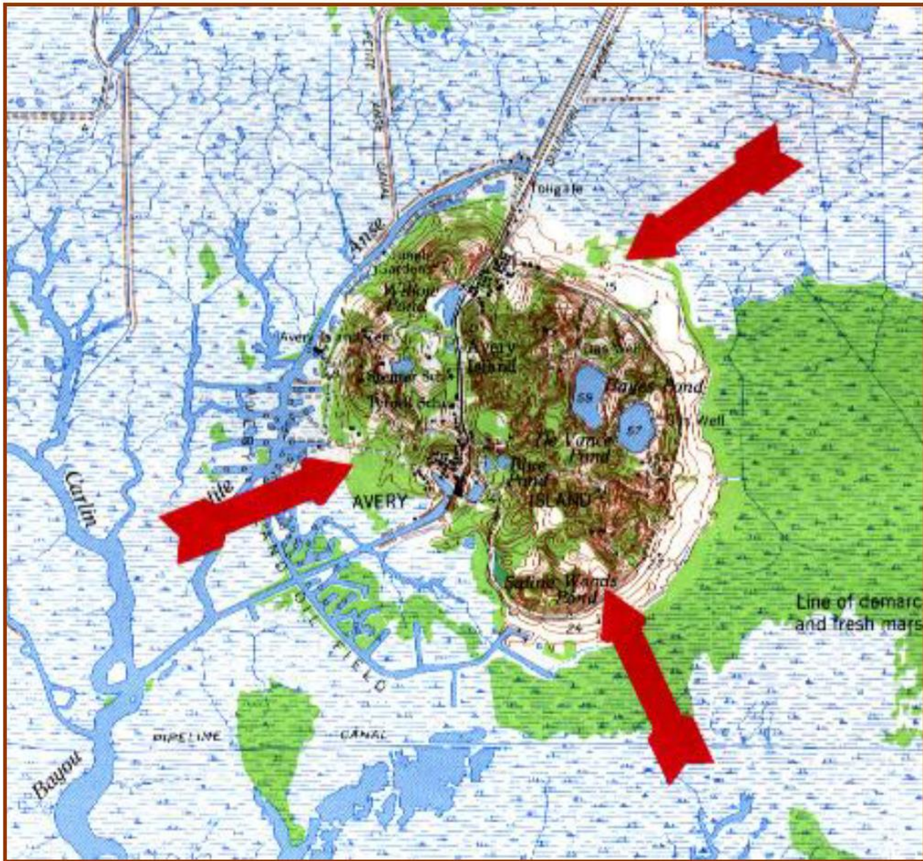
Gambar 13-16 Peta Topografi Kubah Garam ( Dome structures ) dan Pola Aliran Annular
