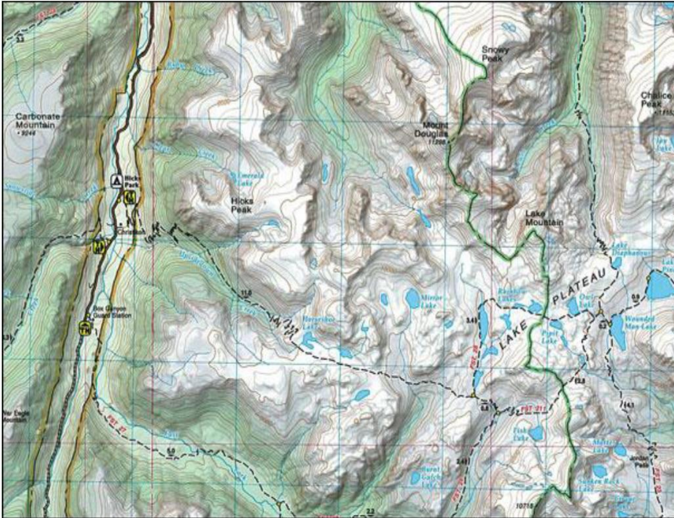
Gambar 13-13 Peta topografi yang memperlihatkan kontrol Kekar dan Sesar: Pola aliran rectangular, kelurusan (lineament) bukit, kelurusan sebaran danau.
