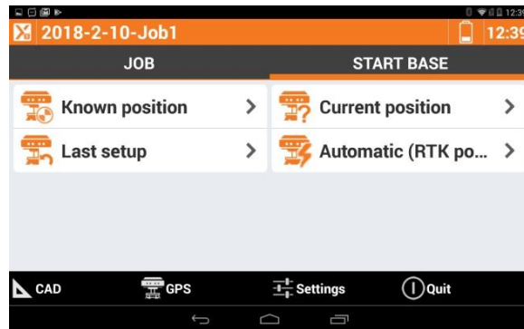
Gambar 5 Tampilan jendela Start Base tempat memulai proses pengukuran metode RTK pada mode Base
