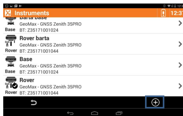
Gambar 12 : Tampilan jendela instrument tempat melakukan setting konfigurasi instrument
