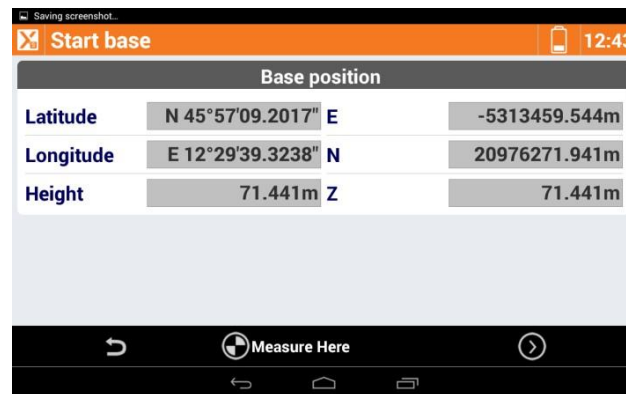
Gambar 7 Tampilan jendela Base Position untuk pendefinisian nilai koordinat tempat berdiri instrument
